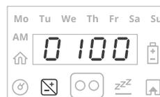
Con las flechas de desplazamiento, ajuste el tiempo de corte asignado (en %) y pulse **OK** para confirmar.
