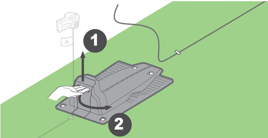
Führen bzw. bringen Sie den Draht durch den vorgesehenen Tunnel und führen ihn durch die Öffnung unterhalb des Ladesteckverbinders, bis er hinten an der Ladestation herauskommt.
