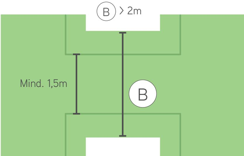
Bei einem Engpass zwischen 1 und 2 Metern (3 und 6 Fuß) sollten die Drähte in der Mitte des Pfads mit dem RoboRuler-Abstand 1 dazwischen montiert werden, damit der Mäher dem Draht innerhalb und außerhalb der Nebenzone folgen kann. Sie sollten am Pfadeingang aus beiden Richtungen einen Winkel von 45 Grad aussparen, damit der Mäher innerhalb und außerhalb der schmalen Durchfahrt präzise wenden kann.
