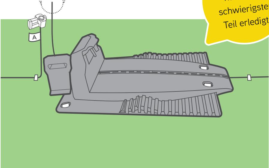
Befestigen Sie den Draht am Boden. Verdrillen und wickeln Sie den Draht, sodass er genau in des Fach der Ladestation passt. Verbinden Sie das mit „A“ markierte Drahtende mit dem mit A markierten Steckverbinder an der Rückseite der Ladestation. Verbinden Sie das andere Ende mit dem anderen Steckverbinder. Stecken Sie den Draht hinein und schließen Sie die Klappe.
