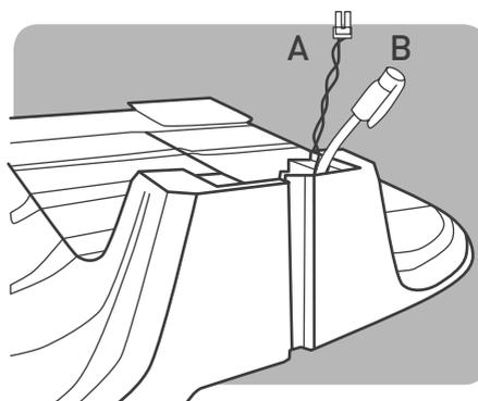
Conecte el conector del cable perimetral al punto A en el cabezal de la estación base. Conecte el cable de extensión de 20 metros al punto B en el cabezal de la estación base.
