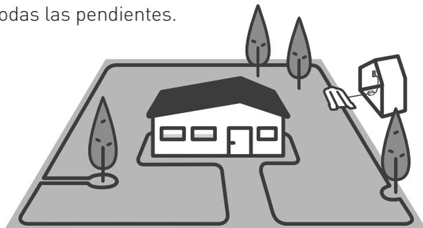
Extraiga unos 30 cm de cable a través del agujero en la cubierta de plástico del carrete y fije el comienzo del cable al suelo, en el sitio en que planea instalar la estación base.
