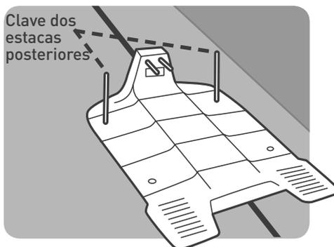
Al martillar las estacas, tenga cuidado de no dañar las tuberías de riego.
