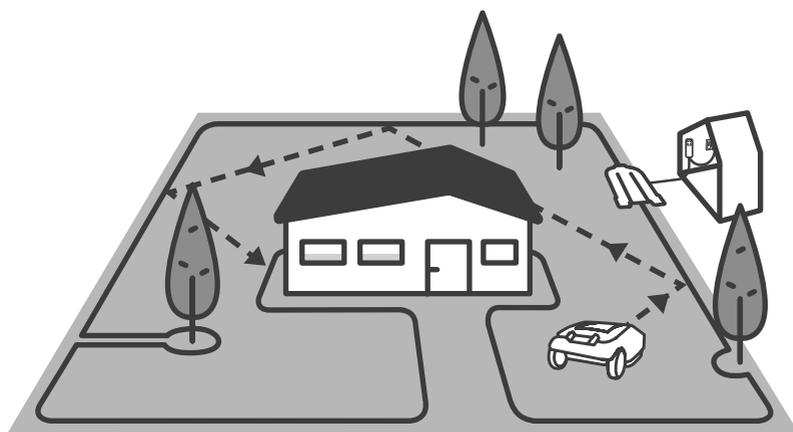
La cortadora de césped se desplazará al azar dentro de su área de trabajo, según lo definido por el cable perimetral. Este tipo de movimiento aleatorio proporciona el corte perfecto y asegura una cobertura completa del césped.
