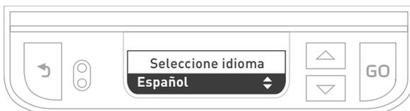
Utilice las flechas para seleccionar el valor deseado. Pulse GO para confirmar la selección y pase al elemento siguiente. Para retroceder un paso o cancelar una acción, pulse la flecha de retroceso.
