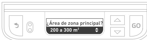
Indique el tamaño de su área de zona principal. El mensaje que se abre «Probar la posición del cable» significa que la cortadora de césped está lista para la prueba. Pulse GO. Comenzará a moverse.
