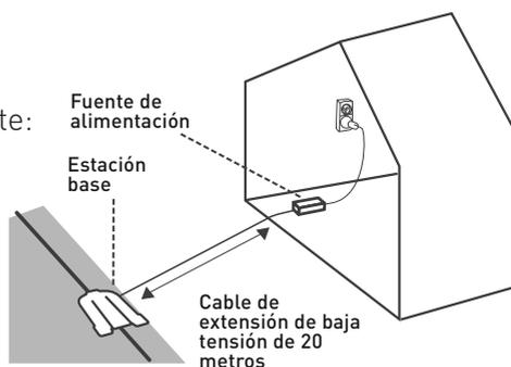
Conecte el cable de corriente continua de la fuente de alimentación al cable de extensión de 20 metros.
