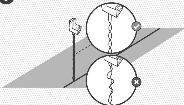
Pele 5 mm del aislamiento de los extremos del cable, introduzca el cable trenzado en el conector y sujételo mediante un pequeño destornillador plano.
